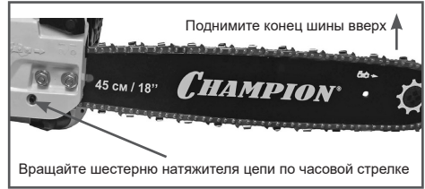
Рис. 5 Регулировка натяжения цепи
