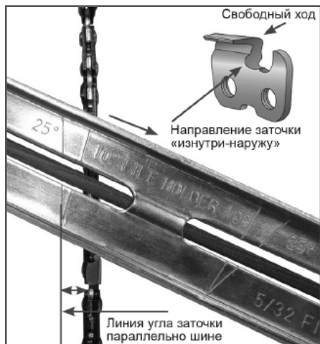
Рис. 28 Определение угла заточки
